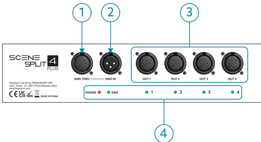
1. **DMX Thru:** L'uscita DMX Thru può essere utilizzata per collegare ulteriori splitter DMX, controller o amplificatori, senza alterare il segnale DMX originale. Questo garantisce l'integrità del segnale e offre flessibilità in caso di configurazioni di illuminazione complesse.
