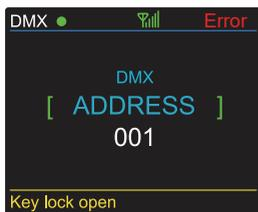
Quando l'indicatore di temperatura nell'angolo in alto a destra mostra ERROR in rosso, significa che ci sono problemi di temperatura con l'apparecchio.
