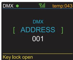
Quando l'indicatore di temperatura nell'angolo in alto a destra passa da bianco a giallo, significa che la temperatura ha superato le impostazioni massime predefinite.
