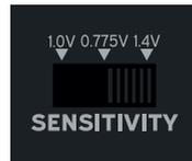
Questo selettore a 3 posizioni consente di selezionare la sensibilità del segnale di ingresso in modo da avere sempre un margine adeguato (headroom) tra il livello nominale di un segnale e il livello massimo che l'amplificatore può gestire correttamente prima che si verifichi la saturazione con conseguente riduzione del segnale. Questo selettore permette di scegliere, come sensibilità d'ingresso: 1.0V=13dB, 0,775V=0dB, 1,4V=26dB.
