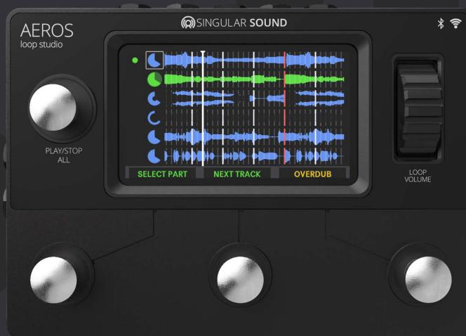
Nell’immagine a fianco, Aeros indica che la traccia superiore, Track 1, è bloccata. Ciò significa che verrà riprodotta in ogni parte della canzone. Tutte le modifiche effettuate sulla traccia influenzano ogni parte della canzone.
