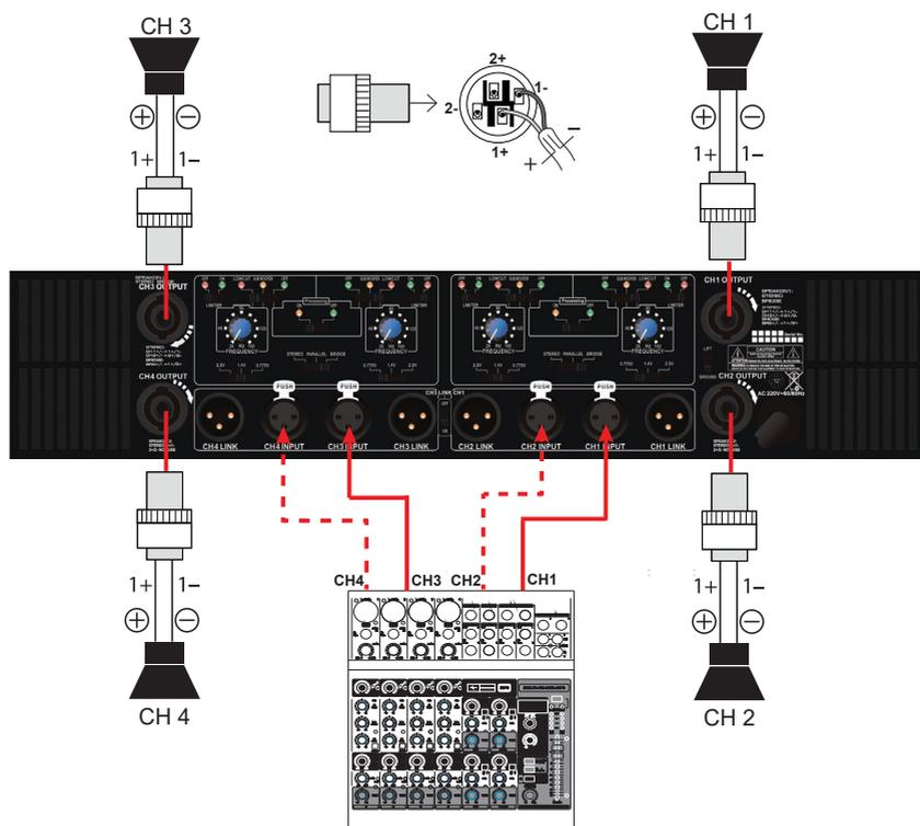
Il MODO PARALLELO, con un ingresso mono e due uscite mono, consente di inserire un segnale mono in un ingresso ed avere il segnale mono in entrambe le uscite, con controlli di livello regolabili separatamente. Il segnale di ingresso (CH1 o CH2 / CH3 o CH4) sarà presente su entrambi i canali di uscita (CH1 e CH2 / CH3 e CH4).
