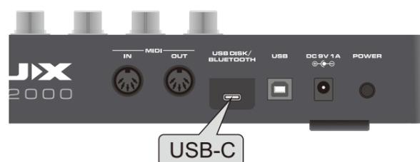
L'interfaccia USB-C (USB DISK / BLUETOOTH) del pannello posteriore è l'interfaccia del disco U / modulo Bluetooth. Entrambi possono essere collegati solo uno, non utilizzare il dispositivo di espansione per collegare il disco U e il modulo Bluetooth. Quando è collegato al modulo Bluetooth, è possibile utilizzare il telefono cellulare/pad collegato al DP-2000 Bluetooth per riprodurre musica.
