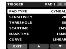
Questa interfaccia consente di regolare la sensibilità e altri parametri di ogni strike pad. Selezionare i parametri da regolare con i tasti F2/F3 e utilizzare la manopola VALUE.
