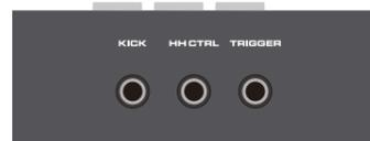
TRIGGER È possibile accedere a qualsiasi singolo piatto o a un singolo pad elettronico, quindi selezionare il dispositivo a cui si accede tramite l'interfaccia TRIGGER PAD TYPE sotto il menu. Se si tratta di piatti, selezionare CYMBAL, se si tratta di tamburi, selezionare DRUM PAD.
