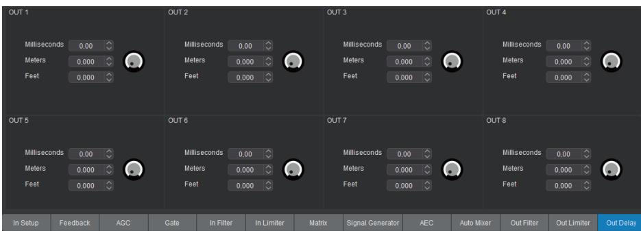
Ogni canale di uscita dispone di un delay indipendente, con un tempo massimo impostabile fino a 300 millisecondi.
