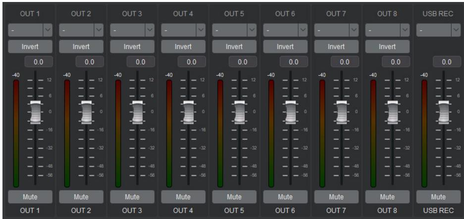
Dopo il Matrix Mix, è possibile monitorare il livello dei fader di ogni canale, controllare il volume, i gruppi, invertire la fase e disattivare (mute) i segnali audio in ingresso. I fader del volume di questa pagina possono essere controllati tramite un protocollo di terze parti.
