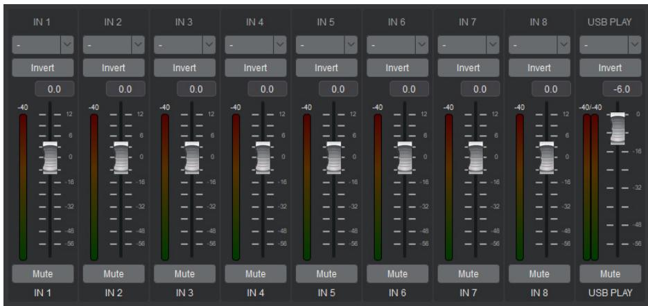
Regola il livello post-fader di ogni canale e controlla il volume, il raggruppamento, la fase e la funzione mute dei segnali audio in ingresso. I fader del volume di questa pagina possono essere controllati tramite protocollo di terze parti.
