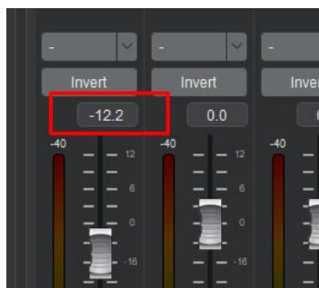
È anche possibile utilizzare i tasti direzionali su/destra e giù/sinistra della tastiera per aumentare o diminuire i valori con incrementi di 0,1 dB. Per la regolazione di parametri complessi come l'equalizzatore parametrico (PEQ) e il limiter, i parametri possono essere copiati e incollati rapidamente, consentendo una facile duplicazione dei dati su più canali con un'operazione semplice e pratica.
