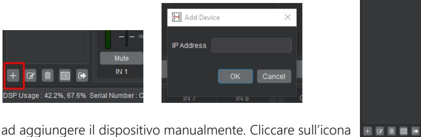
Provare ad aggiungere il dispositivo manualmente. Cliccare sull'icona "+" nell'angolo in basso a sinistra oppure fare clic con il tasto destro del mouse nell'elenco dei dispositivi e selezionare "Add Device". Si aprirà la finestra mostrata sopra: inserire l'indirizzo IP del dispositivo per completare l'aggiunta. L'indirizzo IP del dispositivo è 192.168.1.128.
