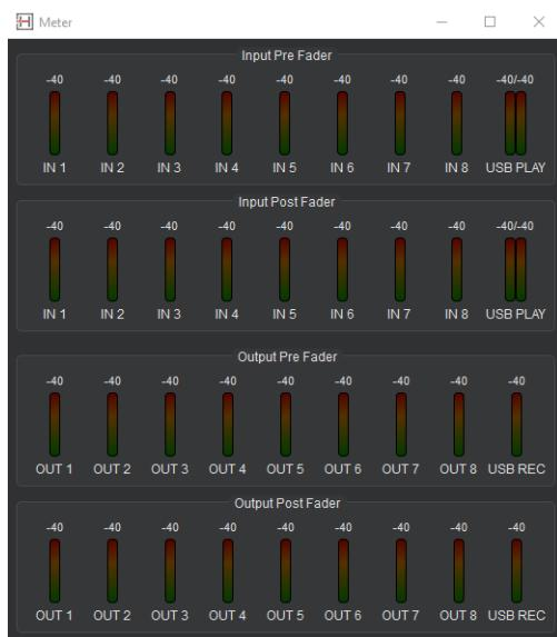
Nella pagina "Meter", è possibile monitorare in tempo reale tutti i livelli pre-fader e post-fader dei canali di ingresso e di uscita.
