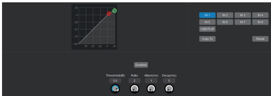
Questo processore supporta un limiter di ingresso indipendente per ciascun canale, con possibilità di regolare attivazione, threshold, ratio, tempo di attacco e tempo di rilascio. I parametri del limiter possono essere copiati e incollati rapidamente, migliorando notevolmente l'efficienza operativa.
