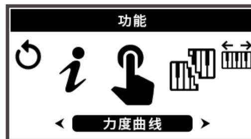
旋转【数据旋钮】选择合适的键盘力度（共5种），按下旋钮确认。
