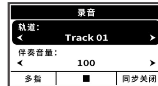
使用【数据旋钮】选择录音的轨道（共5轨），调整伴奏音量、单/多指和弦以及是否同步开启。
