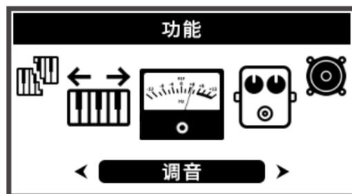
旋转【数据旋钮】调节A4值(425Hz~455Hz)，按下旋钮确认。
