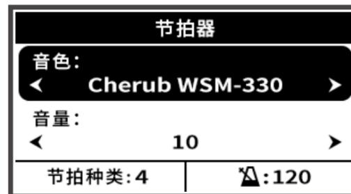
使用【数据旋钮】设置节拍器的音色（4种）、音量、节拍种类（9种）、速度（40bpm~240bpm）。
