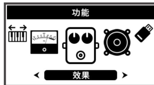
使用【数据旋钮】进入混响选项，可设置混响种类(Room-房间混响、Hall-大厅混响、Plate-板式混响、Off-关闭)及深度(0-100)。
