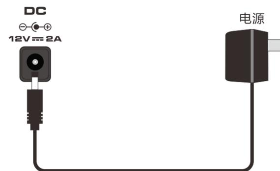
将随机附赠的电源适配器插入NCK-330底部的DC 12V接口，并将电源插头插入供电插座，连接后NCK-330即进入待机模式。
