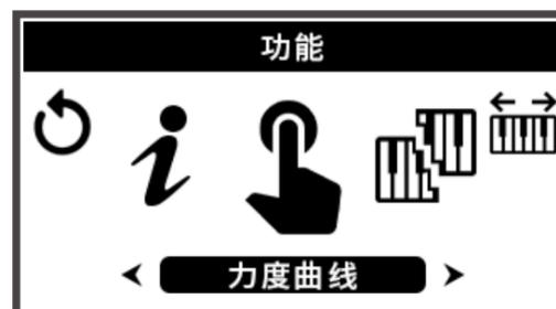
在此界面中，可设置的功能与效果包括：力度曲线、双键盘、移调、A4值调节、效果、扬声器设置、USB AUDIO录音设置、踏板设置、自动关机、蓝牙开关、用户储存预设、恢复出厂设置、查看软件版本。
