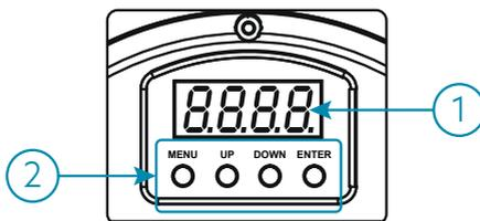
Il pannello di controllo include l'area del display a LED e dei tasti di controllo.
