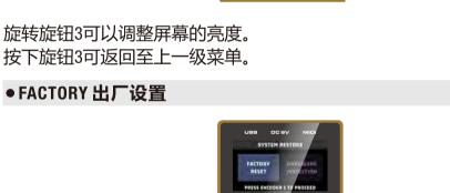
旋转旋钮3可选择FACTORY RESET恢复出厂设置或HARDWARE INSPECTION硬
