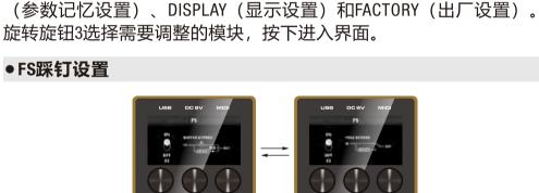
旋转旋钮3可在BUFFER BYPASS缓冲直通和TRUE BYPASS真直通模式中切换。 旋转旋钮2可设置SCENE3 (S3) 场景的开关状态。当S3关闭时,在主界面 下只有S1和S2场景循环切换; 当S3打开时, 可在S1、S2和S3场景中循环 按下旋钮3可返回至上一级菜单。 ● PHONES耳机设置
