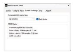
缓冲设置页面允许您查看和设置当前设备ASIO驱动的缓冲区大小。您可以从下拉菜单中选择所需的缓冲区大小。较小的缓冲区设置可减少音频延迟,缓冲区为256 samples或更少时,延迟几乎可以忽略不计。
