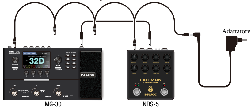
Rumore di Messa a Terra
