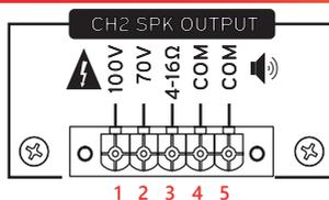
Ogni canale è dotato di un connettore Phoenix (Europlug) a 5 poli per il collegamento ai diffusori.
