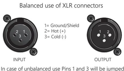
Naturalmente, è possibile collegare apparecchiature sbilanciate a ingressi bilanciati. Utilizzare jack mono e stereo, assicurandosi che l'anello e il collare siano collegati insieme (o i pin 1 e 3 nel caso dei connettori XLR).
