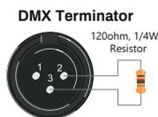
Il DMX è un protocollo di comunicazione resiliente, tuttavia si potrebbero verificare occasionalmente degli errori. Per evitare che il rumore elettrico disturbi e danneggi i segnali di controllo DMX, è consigliabile collegare l'uscita DMX dell'ultimo dispositivo della catena a un terminatore DMX, specialmente se la lunghezza dei cavi è elevata.
