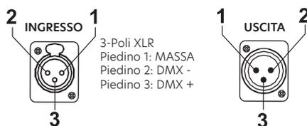
Collegare i dispositivi utilizzando un cavo bipolare schermato a 2 conduttori con connettori XLR maschio-femmina a 3 poli. La connessione dello schermo è il piedino
