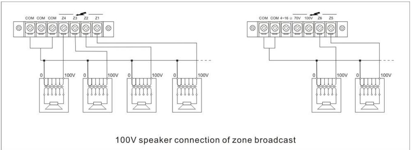
**ATTENZIONE: IL CARICO MASSIMO PER OGNI ZONA E' DI 100W!**
