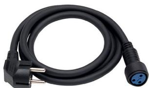
La vostra strobo è dotata di un cavo adattatore di alimentazione di circa 1 m di lunghezza, con una spina Europlug (Schuko) e un connettore impermeabile da Ø30mm. Questo cavo adattatore consente di collegare l'unità alla rete elettrica.
