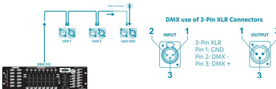
Collegare i dispositivi utilizzando un cavo bipolare schermato a 2 conduttori con connettori XLR maschio-femmina a 3 poli. La connessione dello schermo è il piedino 1, mentre il piedino 2 è negativo (S-) e il piedino 3 è positivo (S+).
