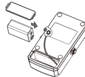
L'unità è dotata di una batteria. Collegare il cavo a scatto alla batteria e inserire la batteria come indicato nel disegno. Quando la batteria si scarica, il suono cambia. In tal caso, sostituire la batteria con una nuova. L'unità si accende quando si inserisce la spina nella presa INPUT. Si raccomanda l'uso di un adattatore CA, poiché il consumo di energia dell'unità è relativamente elevato.
