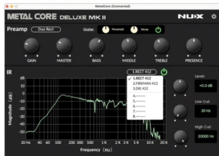
È possibile modificare i parametri e caricare 3 IR attraverso il software di editing MetalCore. Collegare il cavo USB al pedale e al PC, aprire il software di editing, intuitivo e facile da usare. Il software di editing convertirà automaticamente il formato dell'IR, assicuratevi che l'IR sia in formato WAV. METAL CORE DELUXE MKII offre 5 slot utente per caricare 3 IR. (4~8). Supporta una risoluzione di 512 campioni. (È possibile caricare file IR più lunghi).
