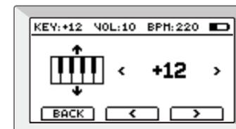
Premere il tasto TRANSPOSE, quindi utilizzare il selettore o i tasti funzione per modificare l'intonazione complessiva della tastiera a passi di semitono (-12/+12). L'intonazione corrente è indicata nell'angolo sinistro dello schermo come "KEY".
