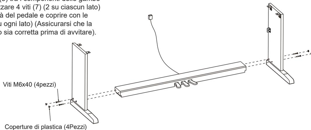
**B.** Fissare il pannello posteriore del supporto (4) all'unità pedali (5) con 4 viti (6) e ai componenti gambe sinistra e destra (2 e 3) con 2 viti (12).
