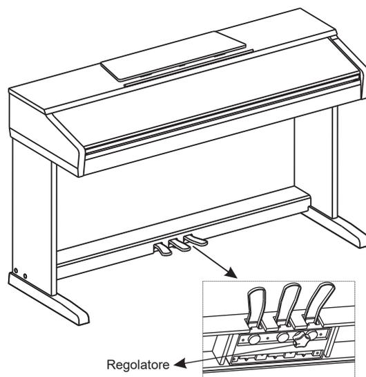
E. Collegare il cavo dell'unità pedali (10) alla presa dei pedali posta nella parte inferiore del pianoforte e collegare l'adattatore di alimentazione AC al terminale DC IN.
