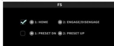
Se si sceglie FS1 (HOME/GLOBAL) come preset down e FS2 (ON/SAVE) come preset up, nel frattempo è possibile premere entrambi i pedali per il bypass.
