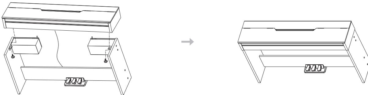
4. Utilizzare le 2 viti 4 x15 e la guarnizione per fissare gli altoparlanti sinistro / destro. Collegare il cavo dell'unità pedali e il cavo degli altoparlanti in base all'etichetta e quindi accendere il pianoforte
